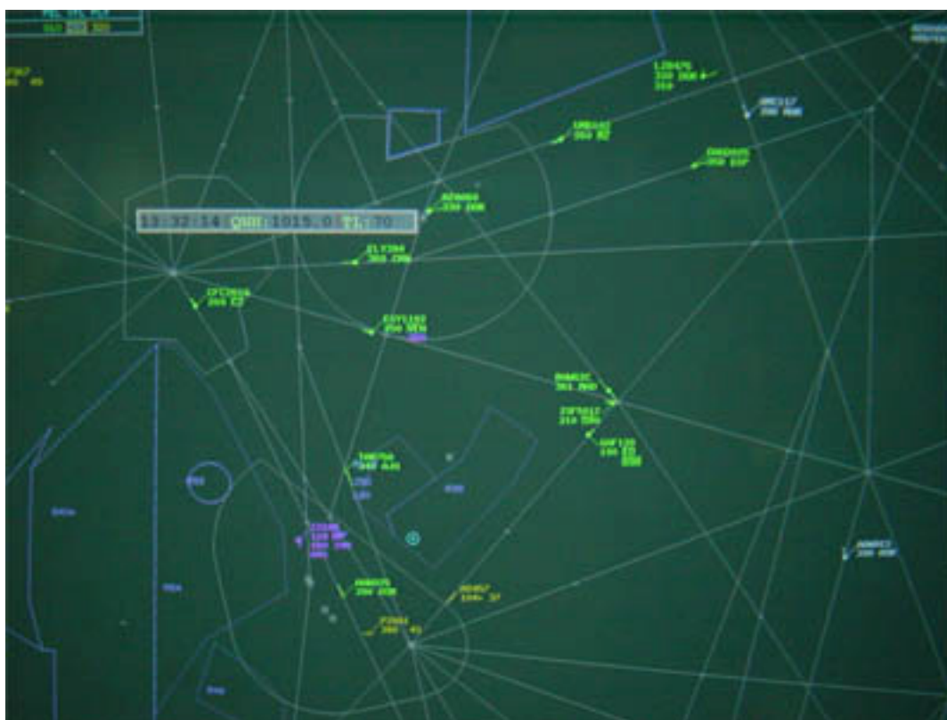
Fig. 1 – La schermata radar mostra la presenza di 13 aeromobili sotto controllo contemporaneo di un controllore (all'interno di un settore di controllo).
